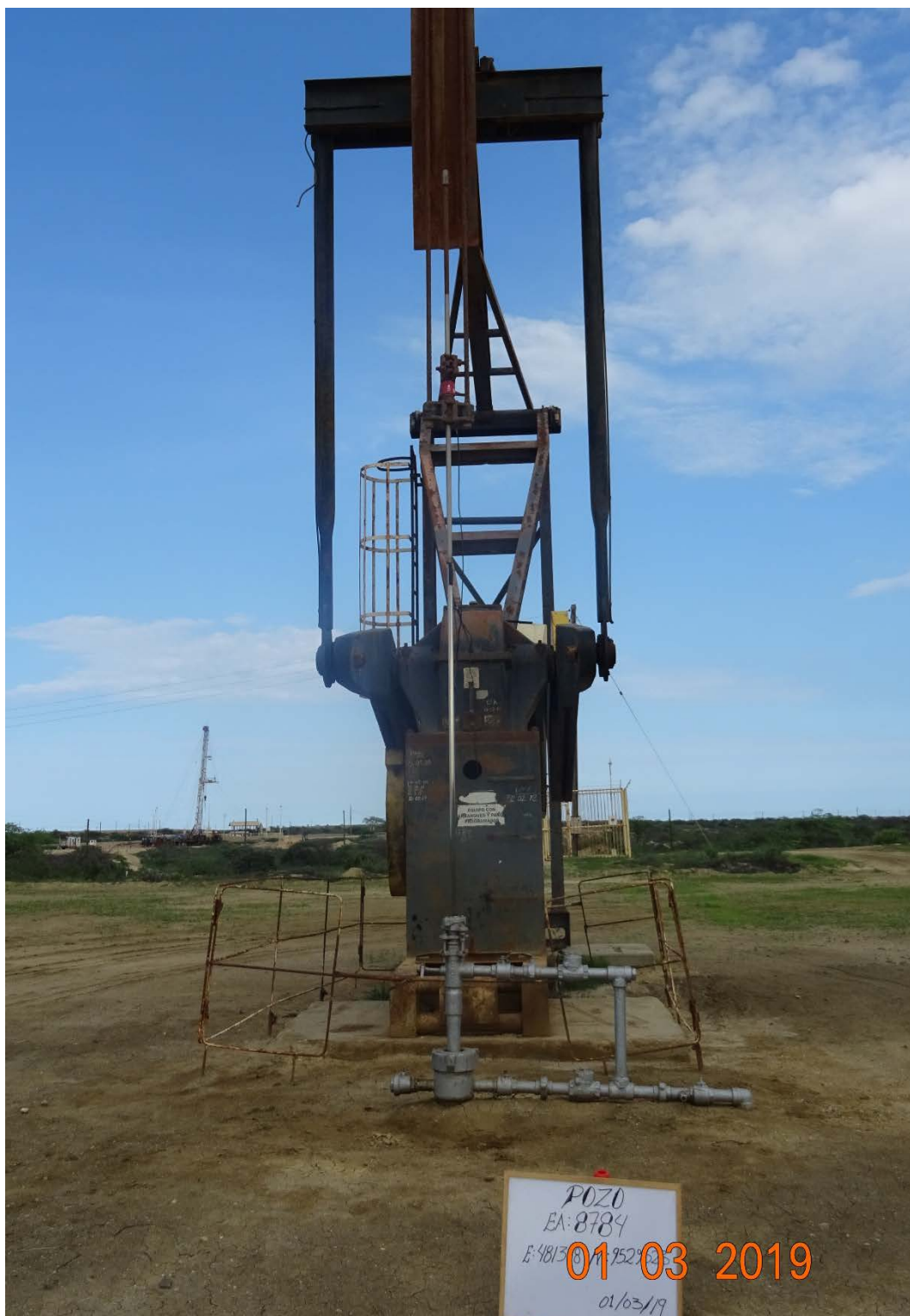
Fotografía 1. Pozo EA8784 (Coordenadas WGS84-zona 17S: 481328mE, 9529523mN), pozo productor tipo BM. Vista desde cerca del pozo. Sin indicio de derrame de hidrocarburos ni alteración de suelo.
