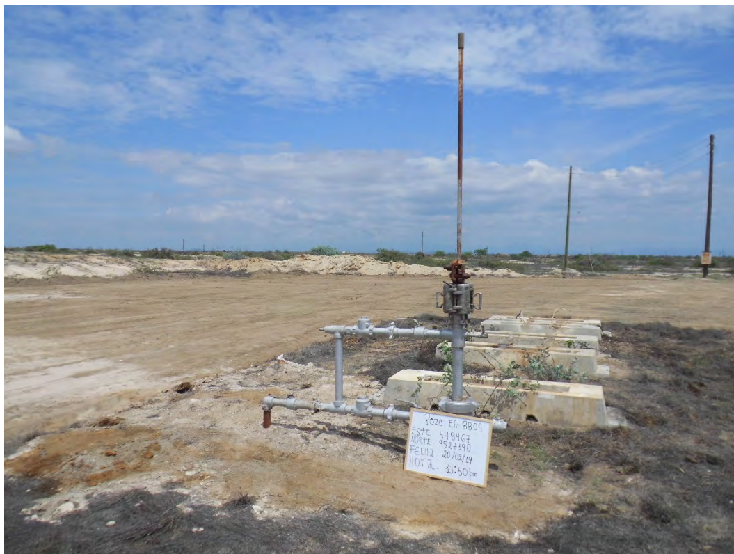
Fotografía 1. Pozo EA8809 (Coordenadas WGS84-zona 17S: 478467mE, 9527190mN), pozo productivo tipo BM. Vista desde cerca del pozo. Sin indicio de derrame de hidrocarburos ni alteración de suelo.
