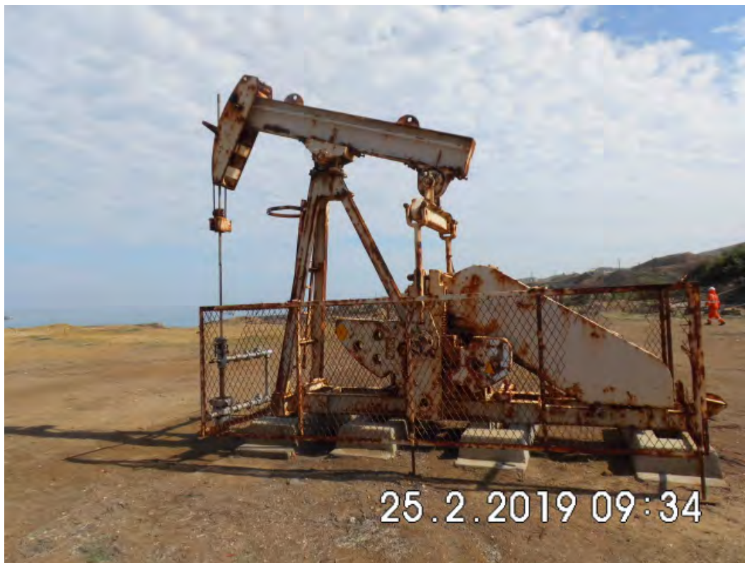
Fotografía 1. Pozo EA8881 (Coordenadas WGS84-zona 17S: 471781mE, 9524746mN), pozo productivo tipo BM. Vista desde cerca del pozo. Sin indicio de derrame de hidrocarburos ni alteración de suelo.
