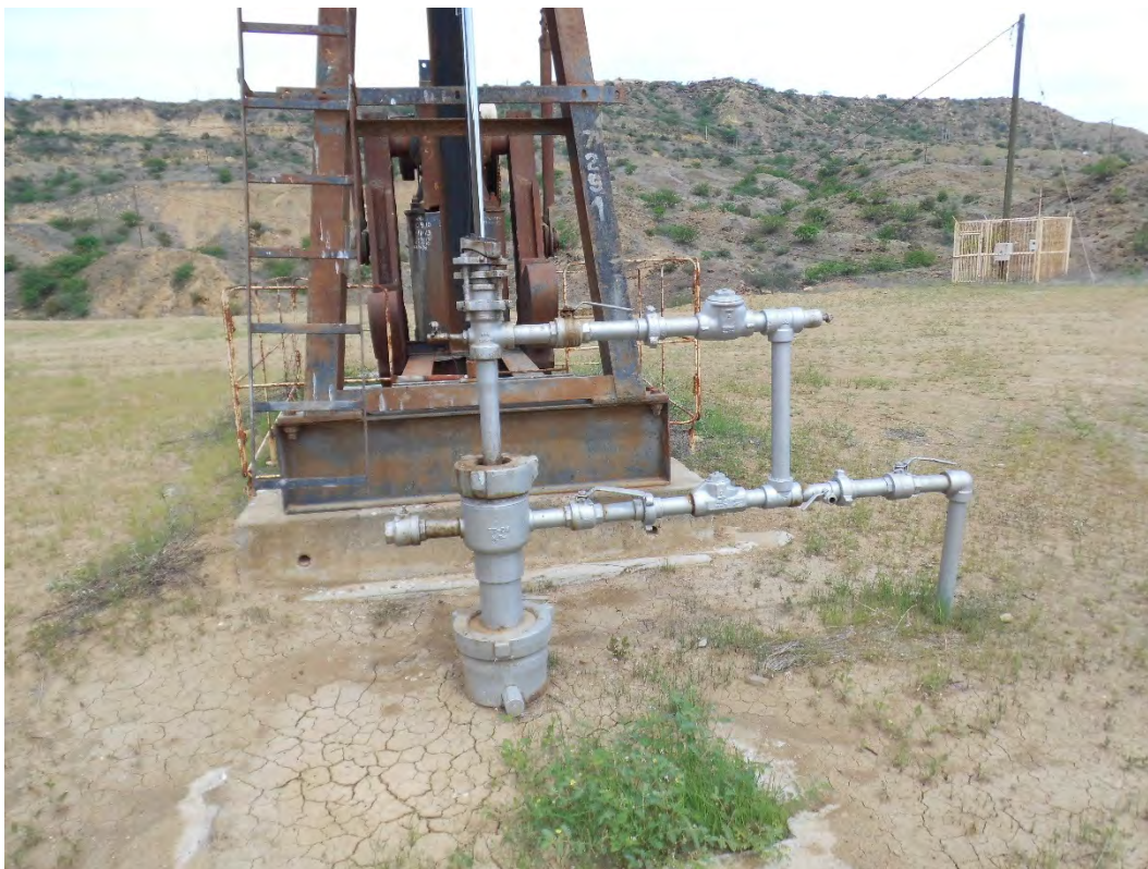
Fotografía 1. Pozo EA8686 (Coordenadas WGS84-zona 17S: 480691mE, 9531622mN), pozo productivo tipo BM. Vista desde cerca del pozo. Sin indicio de derrame de hidrocarburos ni alteración de suelo.
