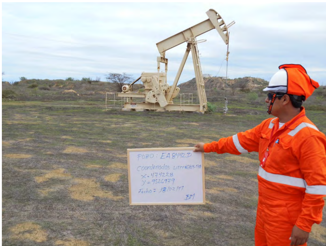
Fotografía 1. Pozo EA8442D (Coordenadas WGS84-zona 17S: 474228mE, 9526979mN), pozo productivo tipo BM. Vista desde cerca del pozo. Sin indicio de derrame de hidrocarburos ni alteración de suelo.
