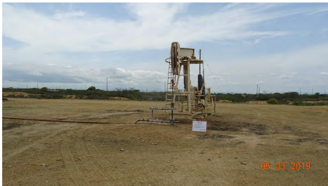
Fotografía 1. Pozo EA8514 (Coordenadas WGS84-zona 17S: 481057mE, 9529165mN), pozo productor tipo BM.
