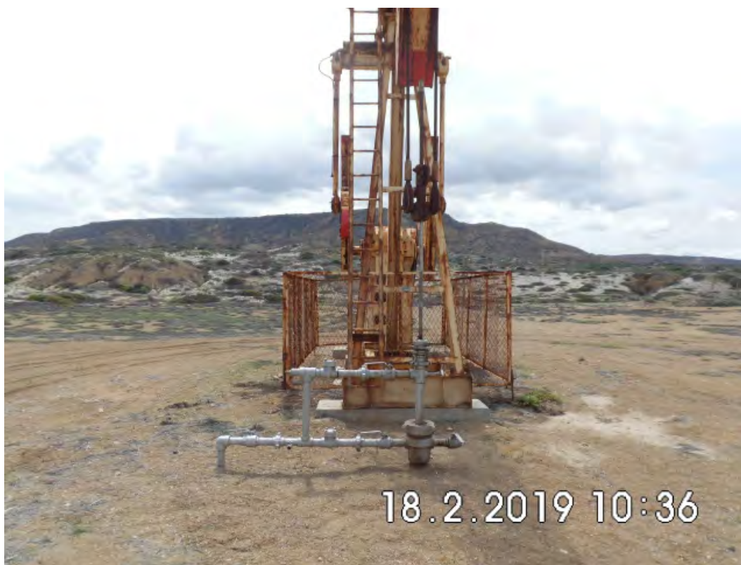
Fotografía 1. Pozo EA8929 (Coordenadas WGS84-zona 17S: 472222mE, 9522393mN), pozo productor tipo BM. Vista desde cerca del pozo. Sin indicio de derrame de hidrocarburos ni alteración de suelo.
