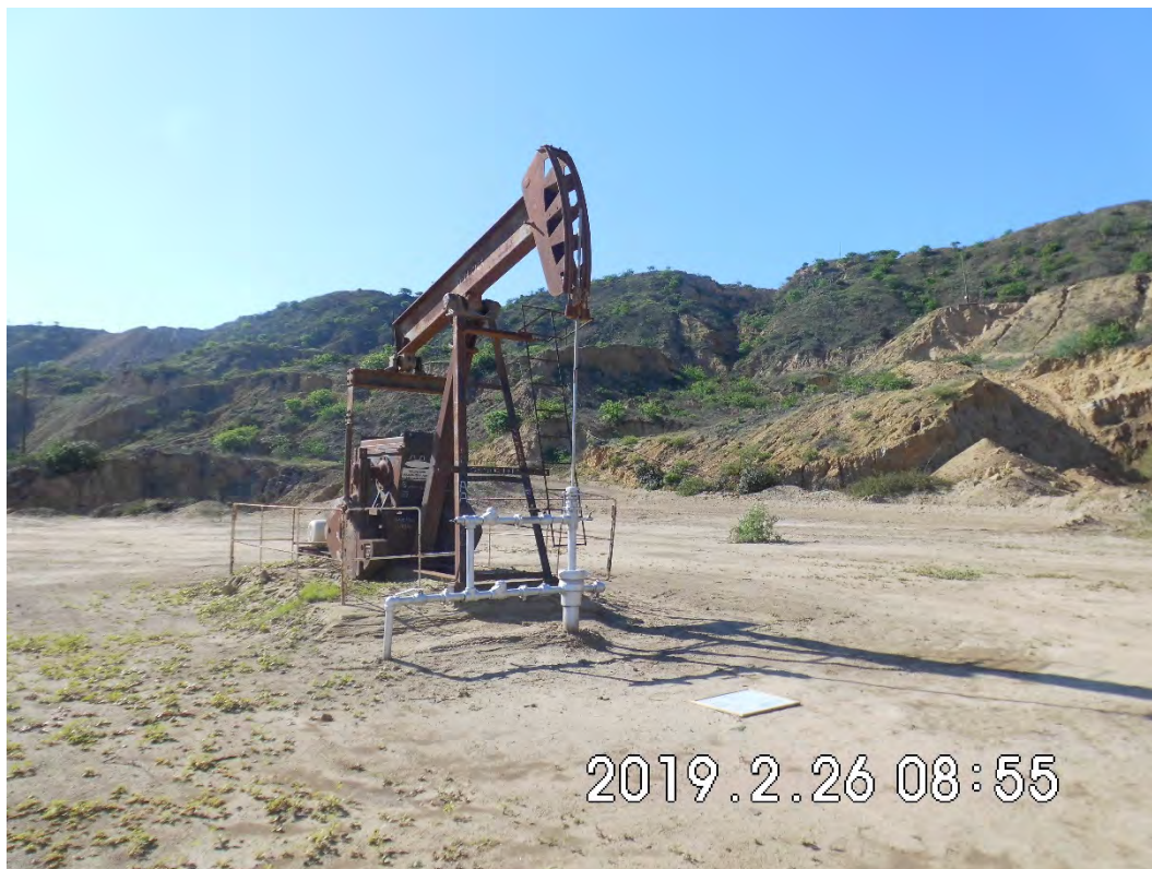
Fotografía 1. Pozo EA8657 (Coordenadas WGS84-zona 17S: 482014mE, 9531251mN), pozo productivo tipo BM. Vista desde cerca del pozo. Sin indicio de derrame de hidrocarburos ni alteración de suelo.
