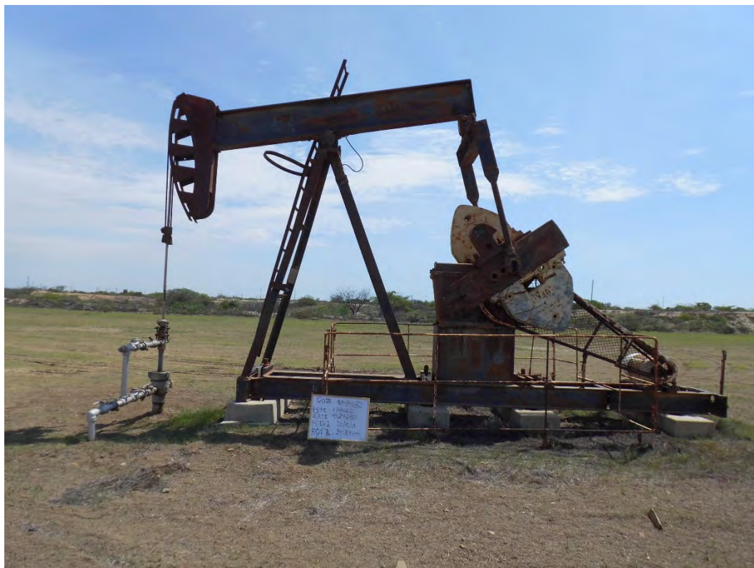
Fotografía 1. Pozo EA8482 (Coordenadas WGS84-zona 17S: 478662mE, 9527180mN), pozo productivo tipo BM. Vista desde cerca del pozo. Sin indicio de derrame de hidrocarburos ni alteración de suelo.
