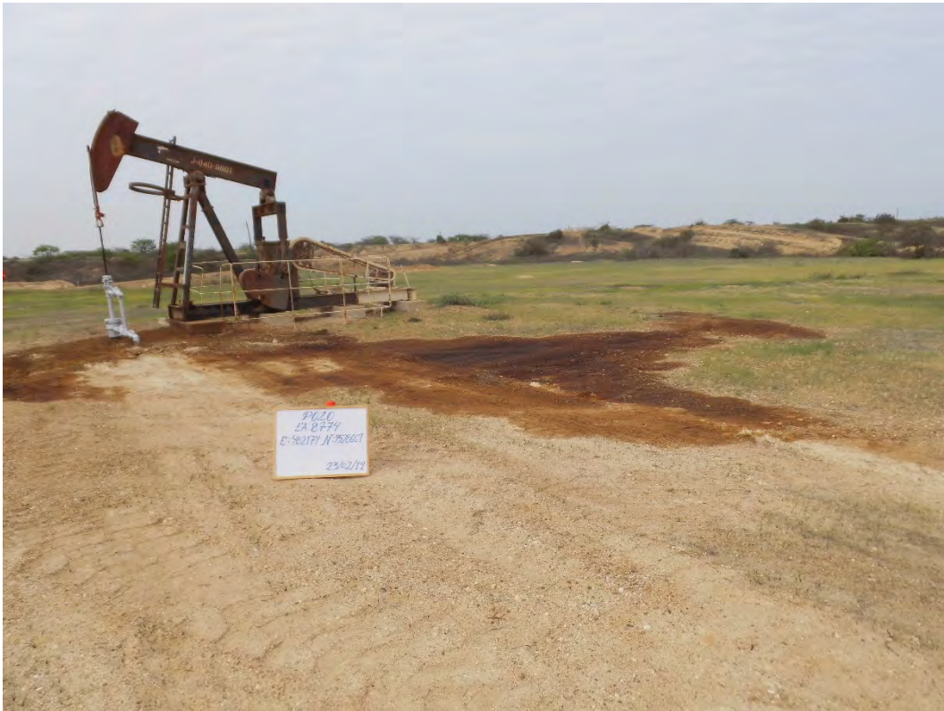
Fotografía 1. Pozo EA8774 (Coordenadas WGS84-zona 17S: 474676mE, 9528608mN), pozo productor tipo BM. Vista desde cerca del pozo. Con indicio de derrame de hidrocarburos y alteración de suelo alrededor del cabezal de pozo con un área de aproximadamente 8 m 2 .
