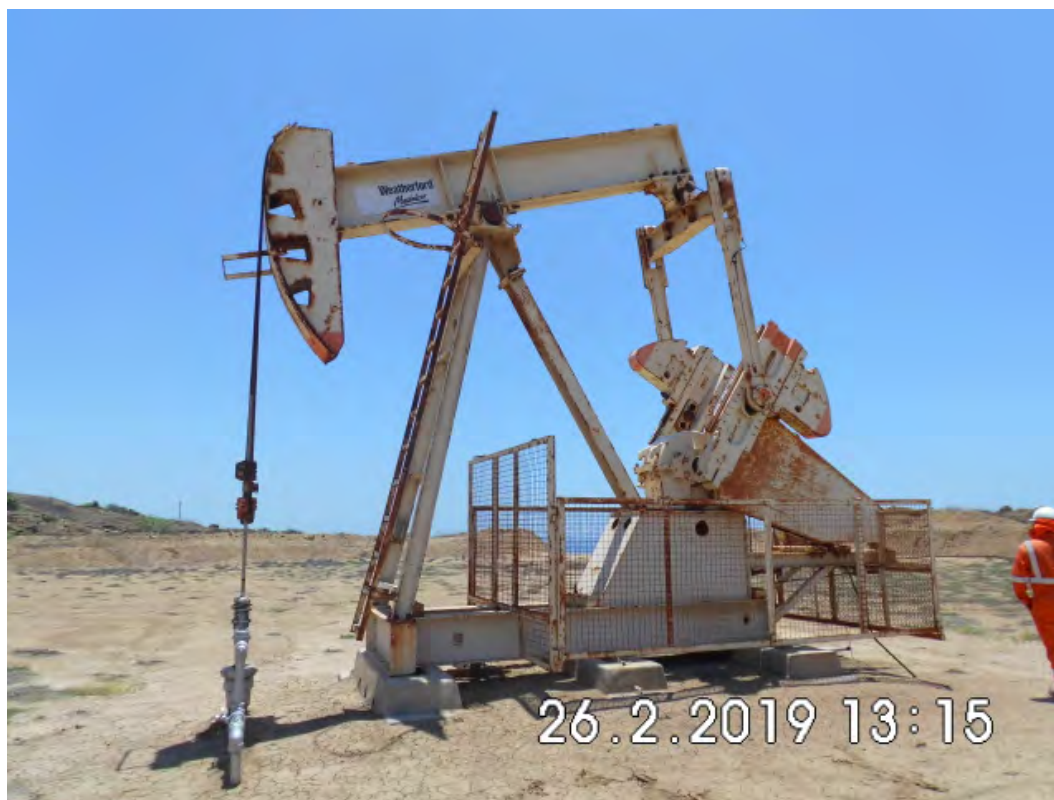
Fotografía 1. Pozo EA8751 (Coordenadas WGS84-zona 17S: 472626mE, 9524806mN), pozo productivo tipo BM. Vista desde cerca del pozo. Sin indicio de derrame de hidrocarburos ni alteración de suelo.
