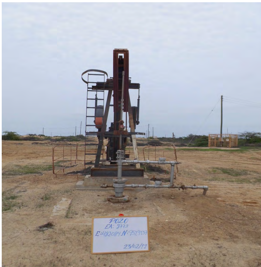
Fotografía 1. Pozo EA8773 (Coordenadas WGS84-zona 17S: 482084mE, 9529137mN), pozo productor tipo BM. Sin indicio de derrame de hidrocarburos ni alteración de suelo.
