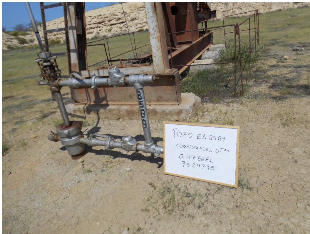
Fotografía 1. Pozo EA8589 (Coordenadas WGS84-zona 17S: 478681mE, 9529795mN), pozo productivo tipo BM. Vista desde cerca del pozo. Sin indicio de derrame de hidrocarburos ni alteración de suelo.
