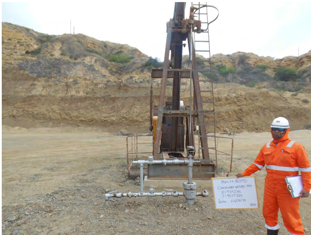
Fotografía 1. Pozo EA8639D (Coordenadas WGS84-zona 17S: 474276mE, 9527324mN), pozo productivo tipo BM. Vista desde cerca del pozo. Sin indicio de derrame de hidrocarburos ni alteración de suelo.
