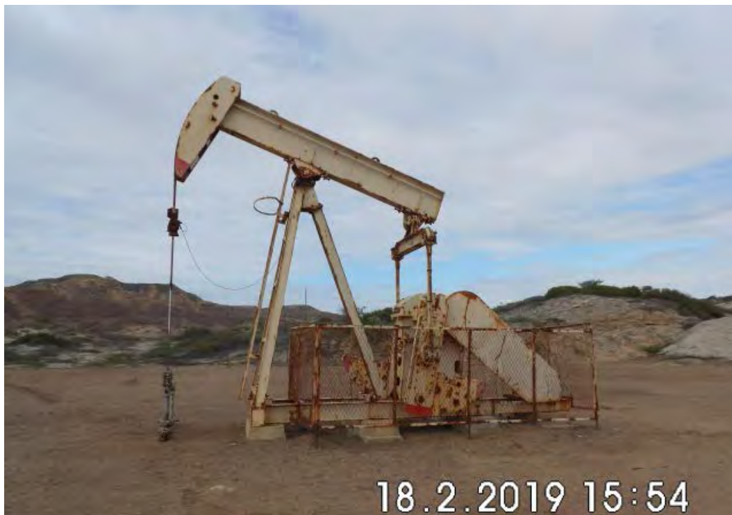
Fotografía 1. Pozo EA8661D (Coordenadas WGS84-zona 17S: 472471 mE, 9522205 mN), pozo productivo tipo BM. Vista desde cerca del pozo. Sin indicio de derrame de hidrocarburos ni alteración de suelo.
