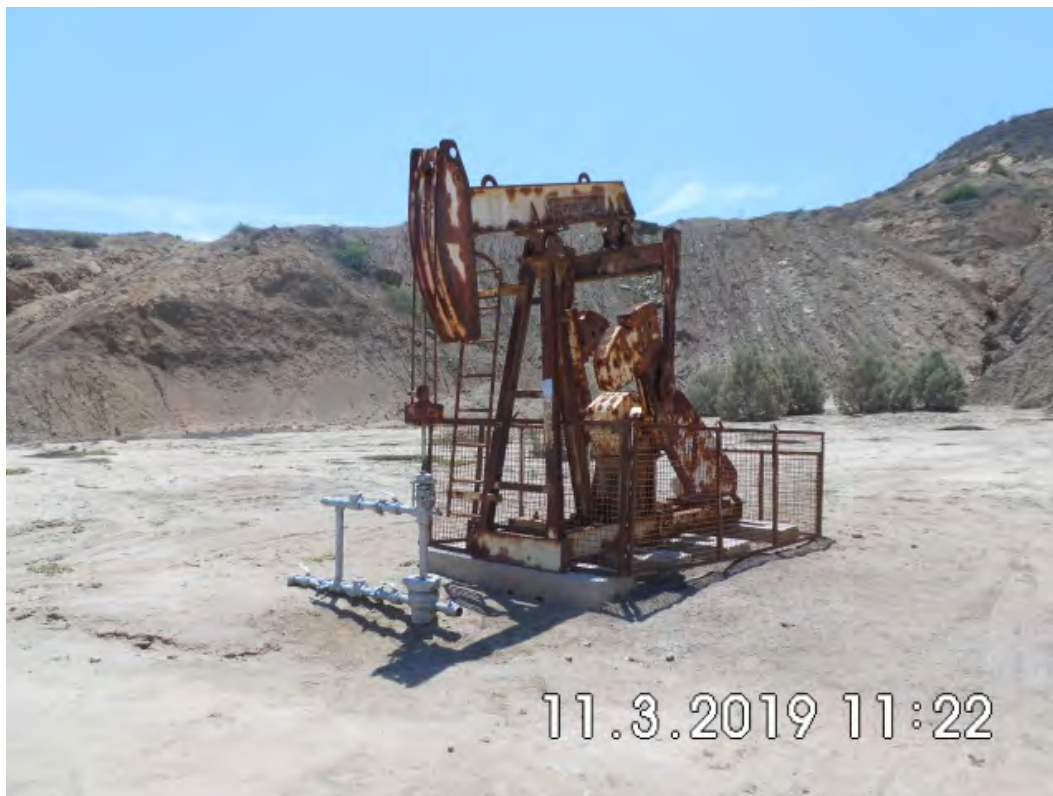
Fotografía 1. Pozo EA8831 (Coordenadas WGS84-zona 17S: 473651mE, 9527196mN), pozo productivo tipo BM. Vista desde cerca del pozo. Sin indicio de derrame de hidrocarburos ni alteración de suelo.
