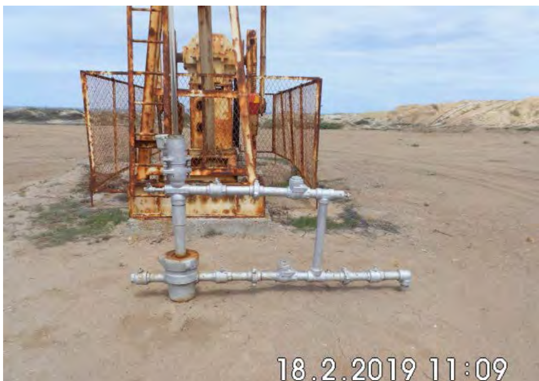
Fotografía 1. Pozo EA8946D (Coordenadas WGS84-zona 17S: 472069mE, 9521879mN), pozo cerrado/inactivo tipo INACTBM. Vista desde cerca del pozo. Sin indicio de derrame de hidrocarburos ni alteración de suelo.
