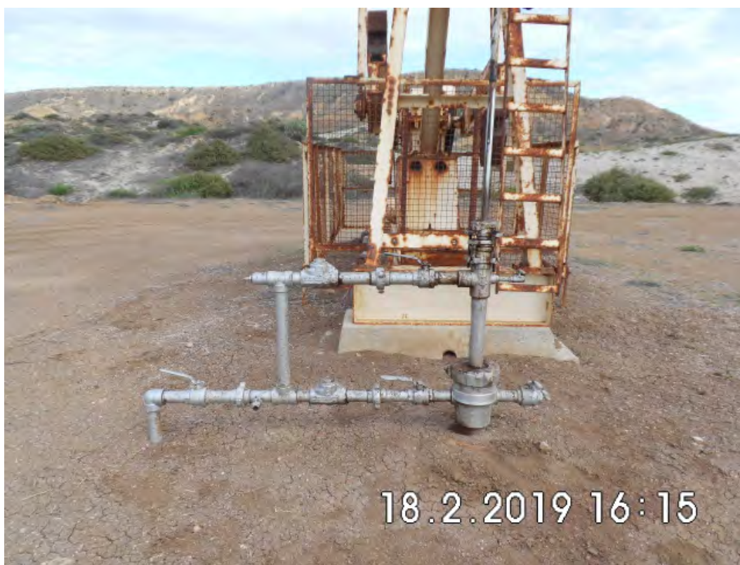
Fotografía 1. Pozo EA8662D (Coordenadas WGS84-zona 17S: 472662mE, 9522326mN), pozo productor tipo BM. Vista desde cerca del pozo. Sin indicio de derrame de hidrocarburos ni alteración de suelo.
