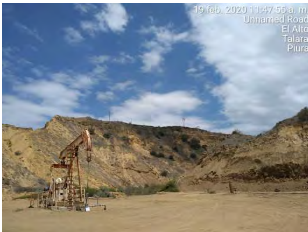
Fotografía 1. Pozo EA8428 (Coordenadas WGS84-zona 17S: 475071mE, 9527076mN), pozo productor tipo BM. Vista de cerca al pozo.
