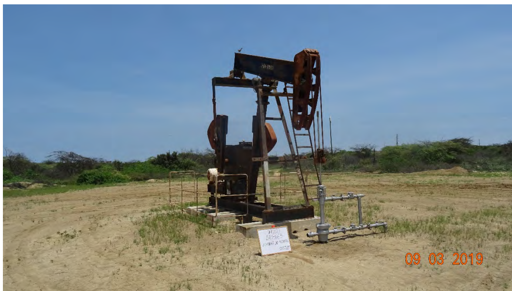
Fotografía 1. Pozo EA8663 (Coordenadas WGS84-zona 17S: 483064mE, 9530302mN), pozo productor tipo BM. Vista desde cerca del pozo. Sin indicio de derrame de hidrocarburos ni alteración de suelo.
