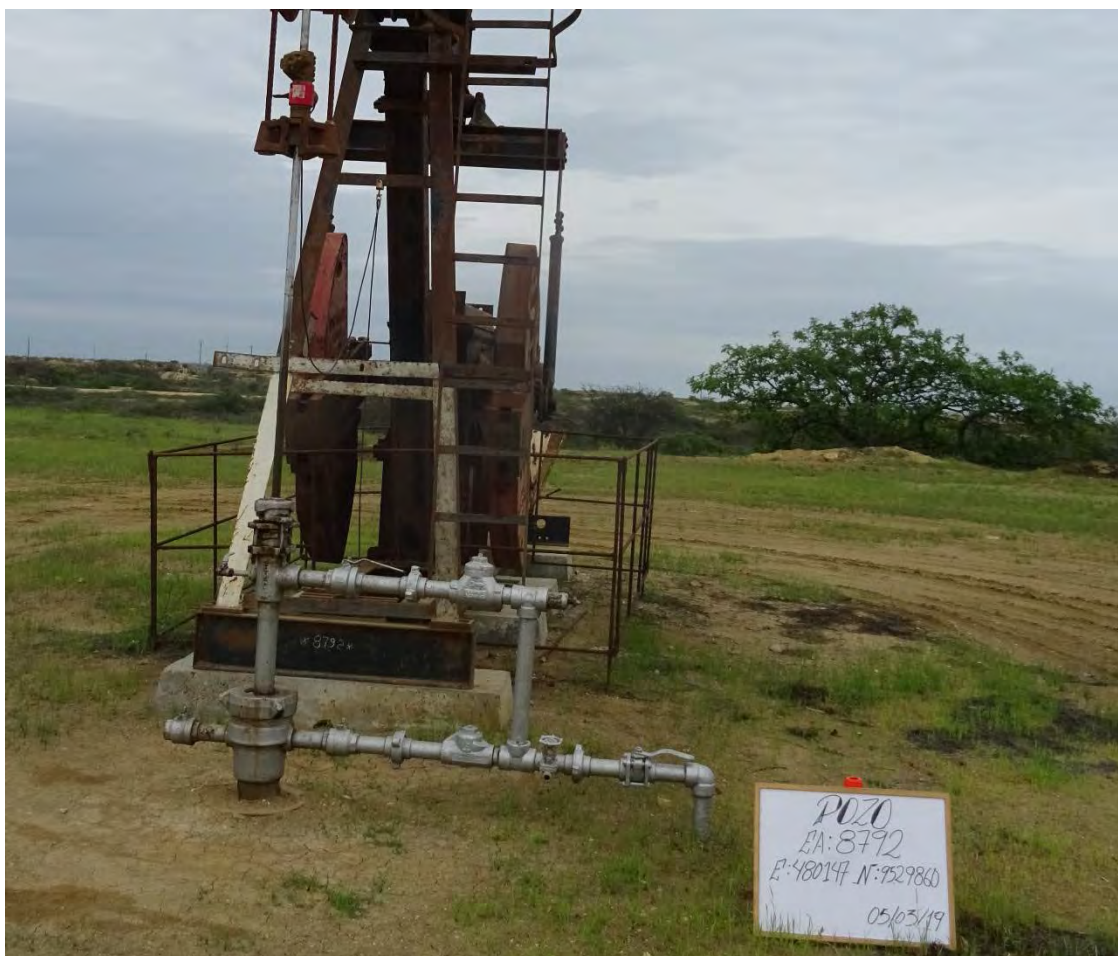
Fotografía 1. Pozo EA8792 (Coordenadas WGS84-zona 17S: 480147mE, 9529860mN), pozo productivo tipo BM. Vista desde cerca del pozo. Sin indicio de derrame de hidrocarburos ni alteración de suelo.
