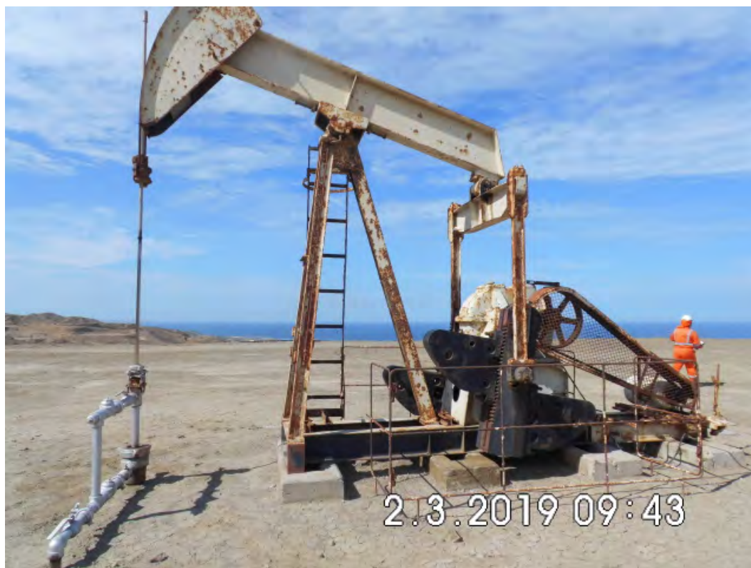
Fotografía 1. Pozo EA8819 (Coordenadas WGS84-zona 17S: 472530mE, 9526518mN), pozo productor tipo BM. Vista de cerca al pozo. Sin indicio de derrame de hidrocarburos ni alteración de suelo.
