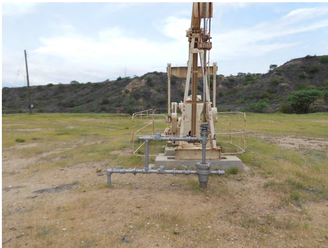
Fotografía 1. Pozo EA8414 (Coordenadas WGS84-zona 17S: 480230mE, 9530691mN), pozo productivo tipo BM. Vista desde cerca del pozo. Sin indicio de derrame de hidrocarburos ni alteración de suelo.
