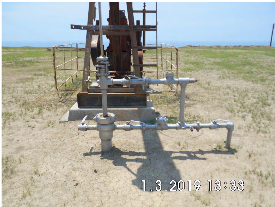
Fotografía 1. Pozo EA8571 (Coordenadas WGS84-zona 17S: 476577mE, 9530606mN), pozo productivo tipo BM. Vista desde cerca del pozo. Sin indicio de derrame de hidrocarburos ni alteración de suelo.
