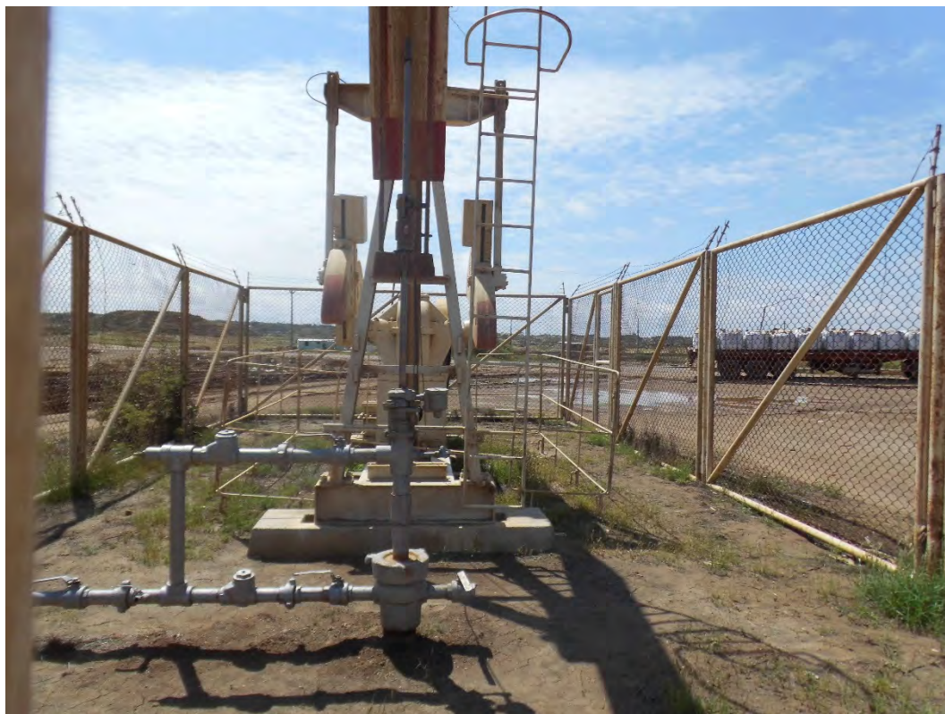
Fotografía 1. Pozo EA8368 (Coordenadas WGS84-zona 17S: 477187mE, 9528658mN), pozo productivo tipo BM. Vista desde cerca del pozo. Sin indicio de derrame de hidrocarburos ni alteración de suelo.
