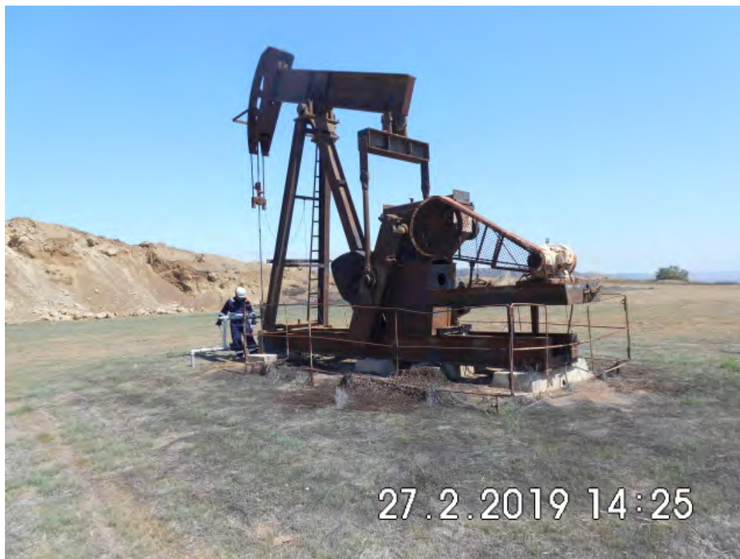
Fotografía 1. Pozo EA8816D (Coordenadas WGS84-zona 17S: 472695mE, 9523573mN), pozo productor tipo BM. Vista de cerca al pozo.
