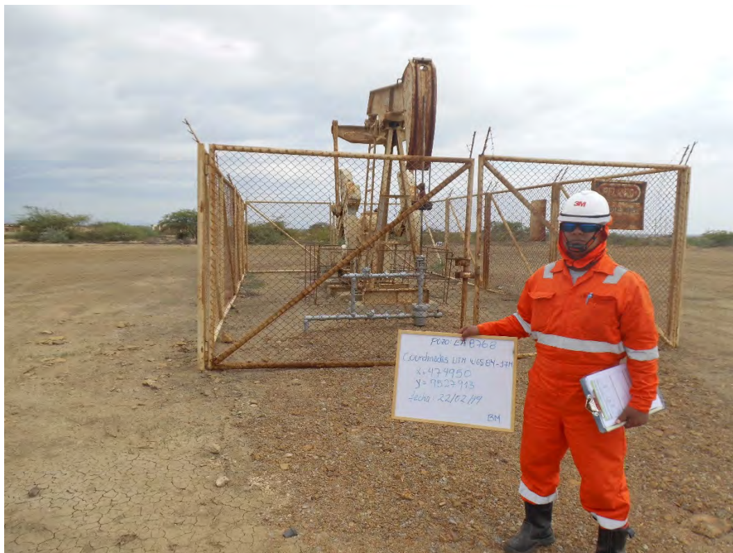
Fotografía 1. Pozo EA8768 (Coordenadas WGS84-zona 17S: 474950mE, 9527913mN), pozo productivo tipo BM. Vista desde cerca del pozo. Sin indicio de derrame de hidrocarburos ni alteración de suelo.
